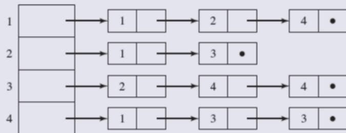
Na figura, o ponto indica um ponteiro nulo, que significa que não há nada mais a se indicar, ou que se chegou ao final da lista. Note que a seta na lista 1 do vértice 2 para o vértice 4 não significa que existe um arco do vértice 2 para o vértice 4; todos os elementos na lista do vértice 1 são adjacentes ao vértice 1, não necessariamente entre si.
