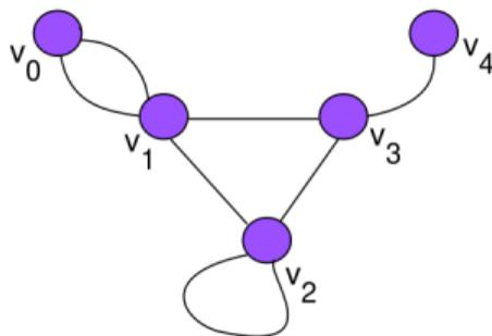
A aresta  $v_2 v_2$  é um laço e entre os vértices  $v_0$  e  $v_1$  temos arestas múltiplas.
